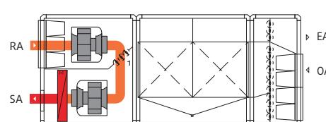
1 Заслонка нагревания рециркуляционного воздуха (дополнительно)
