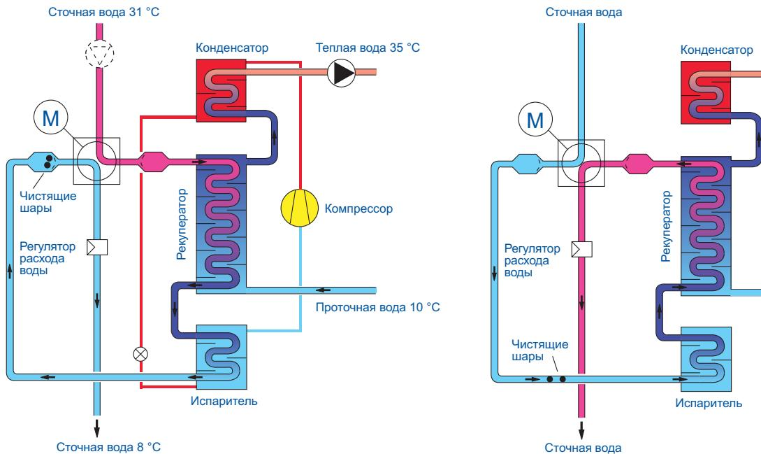
Задачей теплоутилизатора AquaCond является эффективный нагрев холодной проточной воды до температуры воды, требуемой для хозяйственных нужд. При этом в качестве источника тепла служит энергия теплой сточной воды. Передача тепла происходит благодаря комбинированнию рекуперативного теплообменника с тепловым насосом.
