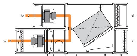
дополнительно открывается заслонка оттаивания рециркуляционного воздуха. Заслонки наружного и выбросного воздуха закрыты.
