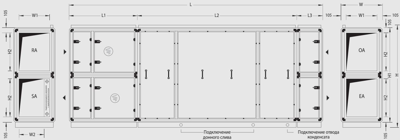
Внимание! При параллельной работе установки каналы приточного и вытяжного воздуха должны быть объединены.
