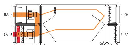
В качестве дополнительной опции установка может быть оснащена системой обхода теплообменника. Доля воздуха, проходящего через
