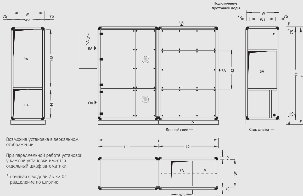
Возможна установка в зеркальном отображении.
