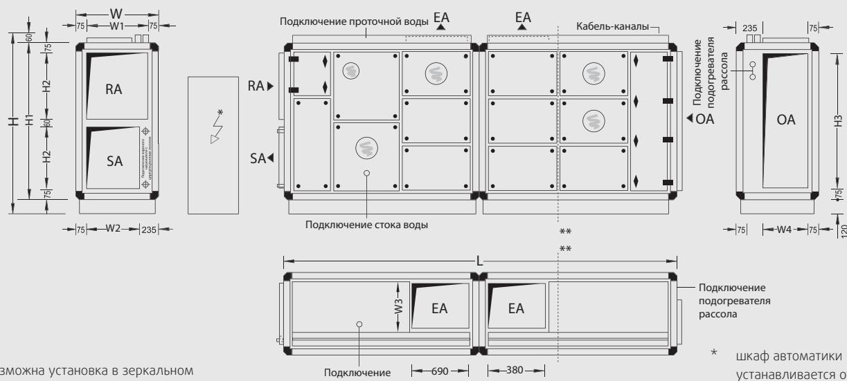
Возможна установка в зеркальном отображении. При параллельной работе установок у каждой установки имеется отдельный шкаф автоматики.
