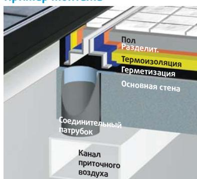
Щелевые диффузоры Menerga обеспечивают равномерное и эффективное распределение воздуха и тепла. Они устанавливаются на фасадах окон плавательных бассейнов, чтобы те не запотевали. При подаче воздуха через щелевые диффузоры на уровне пола не будет чувствоваться тяга воздуха. При этом на сильном солнце не будет образовываться излишнего тепла.
