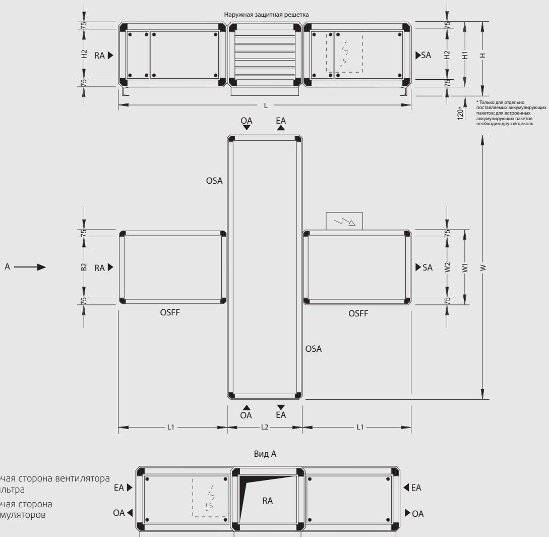
OSFF = рабочая сторона вентилятора и фильтра
