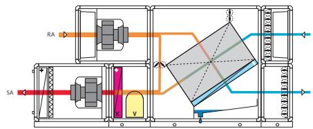
работает в прямоточном режиме через теплообменник. Энергозатраты сводятся к минимуму благодаря умной регулировке расхода воздуха в зависимости от требований.
