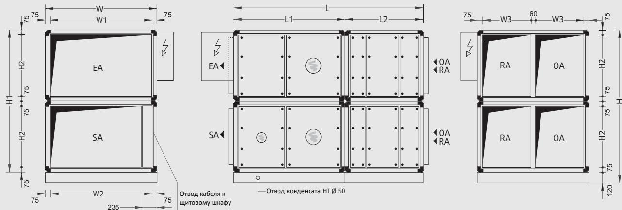
Внимание! При параллельной работе установки каналы приточного и вытяжного воздуха должны быть объединены.
