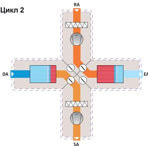
Установка содержит два пакета высокочувствительных теплоаккумулирующих пластин, через которые поочередно циркулируют потоки наружного и вытяжного воздуха. Эти аккумулирующие пластины способны быстро принимать тепло из потока теплого воздуха и также быстро передавать это тепло холодному потоку воздуха.
