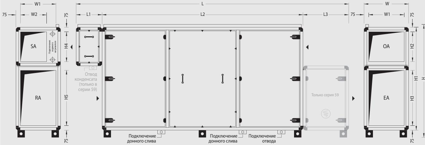
Высота ножек 100 мм Опционально: высота опорных ножек регулируется от 100 до 120 мм
